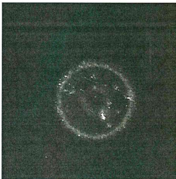
Рис. 8. Микроскопическая фотография характерных разрушений, возникающих при малом превышении порога ЛИР. Размер изображения 1x1 мм 2 .
